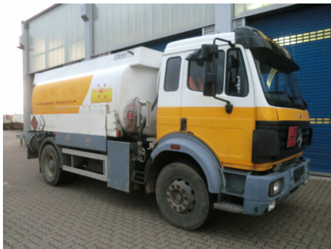
Mercedes-Benz SK 1824 L 4x2 SK 1824 L 4x2, Esterer Tankaufbau ca. 13.100l, 2 Kammern
