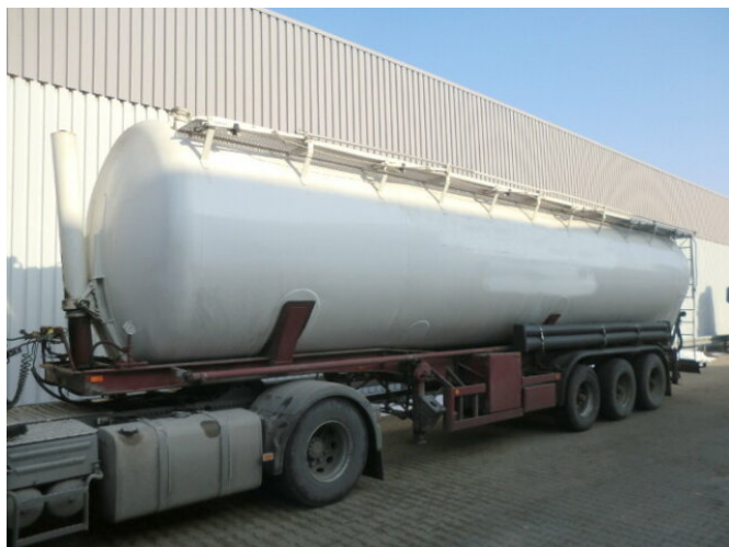
Kässbohrer SSK 56/10-24 SSK 56/10-24, Kippsilo ca. 56m 3
