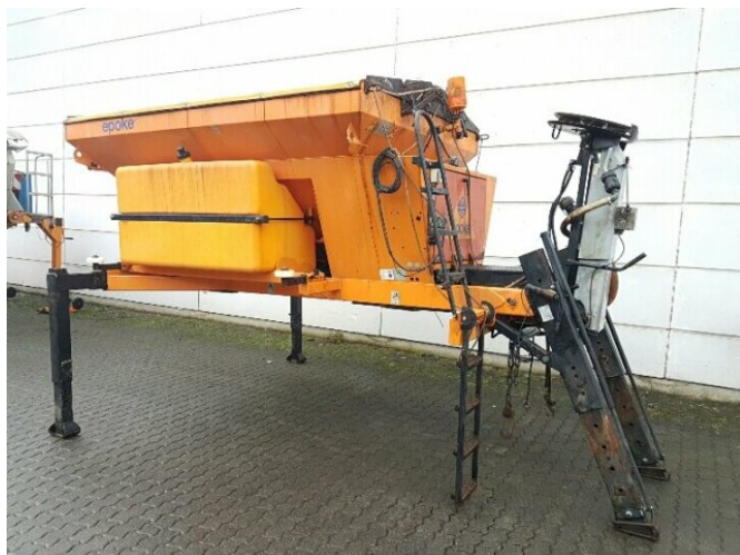
Epoke SH 3500 Epoke Salzstreuer SH 3500 mit Hydraulikantrieb
