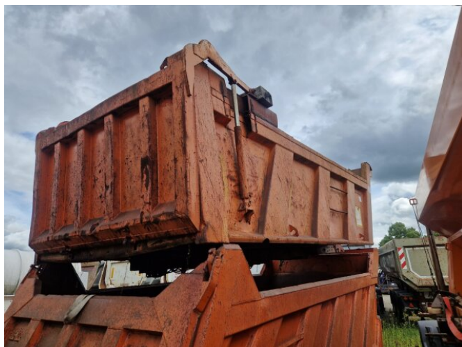
Meiller - Kippaufbau Meiller Stahlmulde, Jet Design 13 cbm
