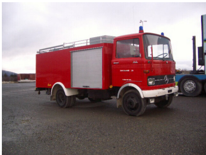
Mercedes-Benz LP 813 4x2 LP 813 4x2 Löschfahrzeug mit Wasserbehälter 2240 l
