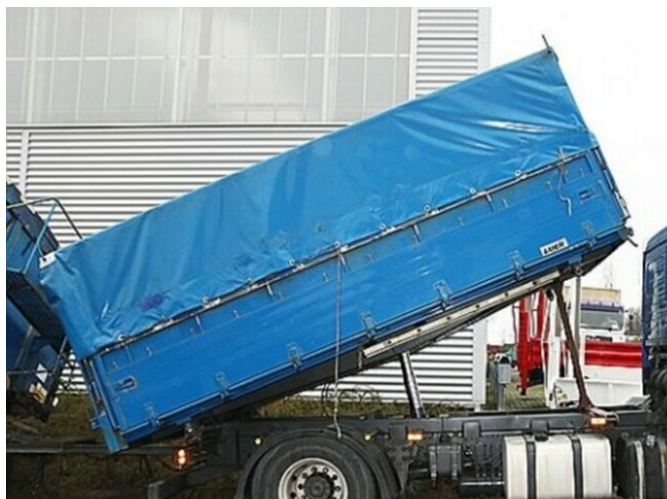
LÜCK - Getreidekipppaufbau Lück Getreidekipppaufbau, ca. 22 cbm
