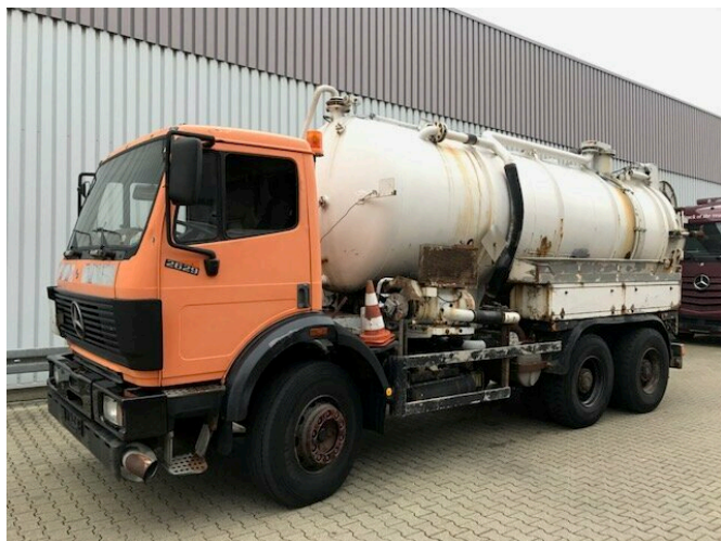
Mercedes-Benz 2629 K 6x4 2629 K 6x4 Kanalreiniger, 14.500l
