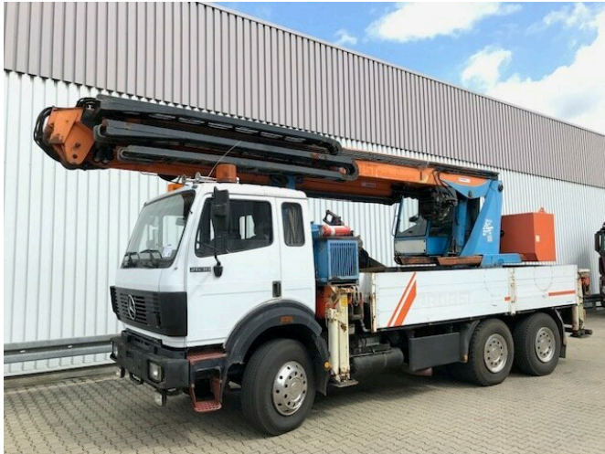
Mercedes-Benz 2638 K 6x4 mit Heckkran Palfinger PK 68000 2638 K 6x4 mit Heckkran Palfinger PK 68000
