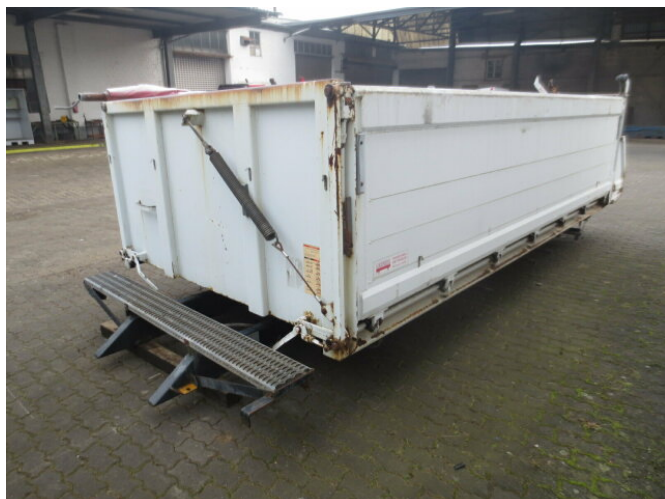
Carnehl 3-S-Kippbrücke, Alu Pendelbordwände und abklappbar, 13 cbm
