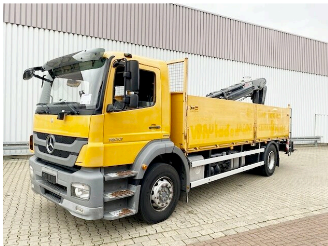
Mercedes-Benz Axor 1833 L 4x2 Axor 1833 L 4x2 mit Heckkran Hiab XS 133 K-2
