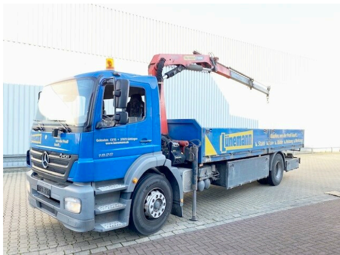
Mercedes-Benz Axor 1828 L 4x2 Axor 1828 L 4x2 mit Kran Palfinger PK 9501, Funk
