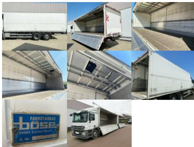
Boese Getränkekoffer Getränkekoffer mit Schwenkbordwänden, Ladegutsicherung
