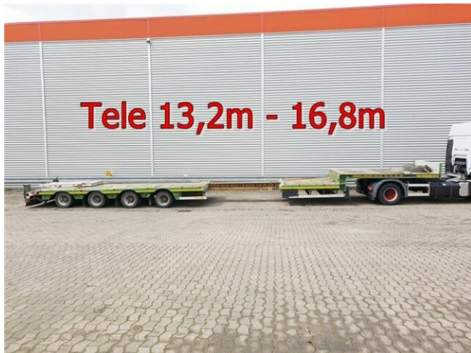
Faymonville STN-4X STN-4AX, Ausziehbar auf 16,8m, 2x Lenkachse
