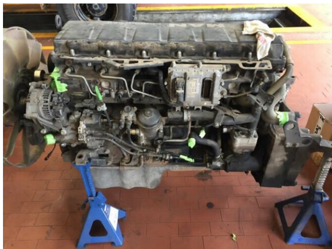
MAN Motor D2066LF31 Motor D2066LF31, 6-Zylinder
