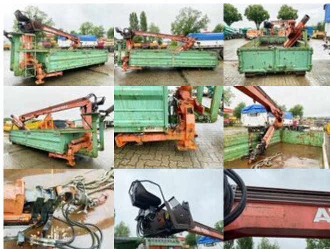
- Abrollcontainer mit Kran Atlas AK 100.1 V 12.8/3 Abrollcontainer mit Flügeltüren & Atlas Kran AK 100.1 V 12.8/3
