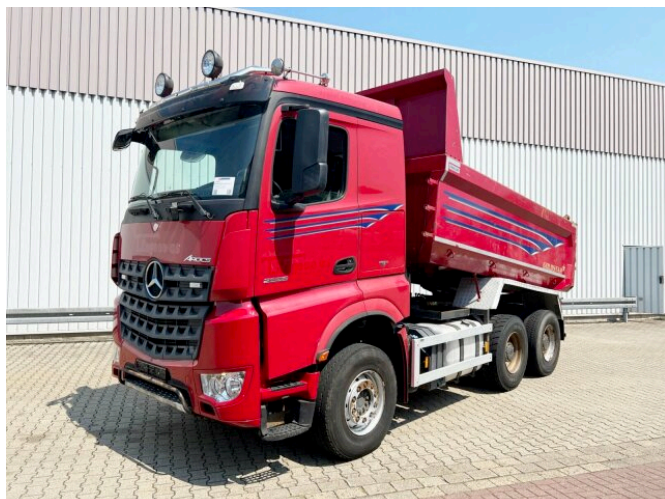
Mercedes-Benz Arocs 2658 K 6x4 Arocs 2658 K 6x4, Retarder, Stahlmulde ca. 11m 3 , hydr. Heckklappenöffnung
