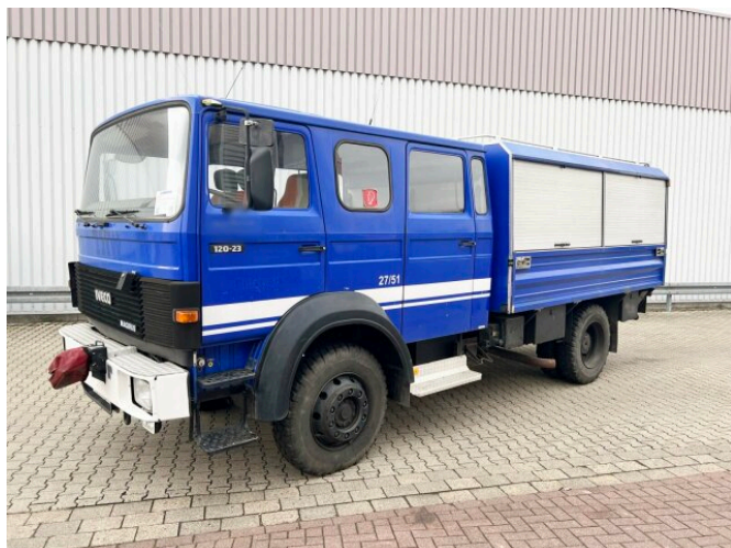
Iveco 120-23 AW 4x4 Doka 120-23 AW 4x4 Doka, V8-Motor, Gerätewagen, Seilwinde
