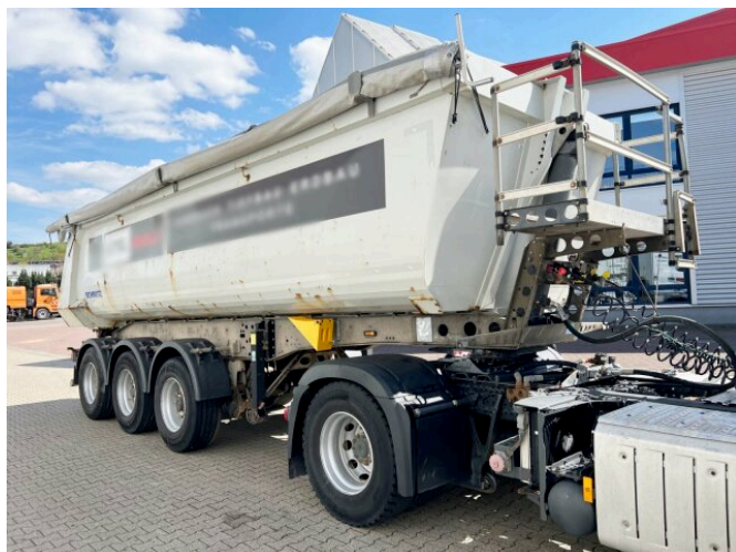
Schmitz SKI 24 SL 7.2 SKI 24 SL 7.2, Stahlmulde ca. 27m³, Liftachse
