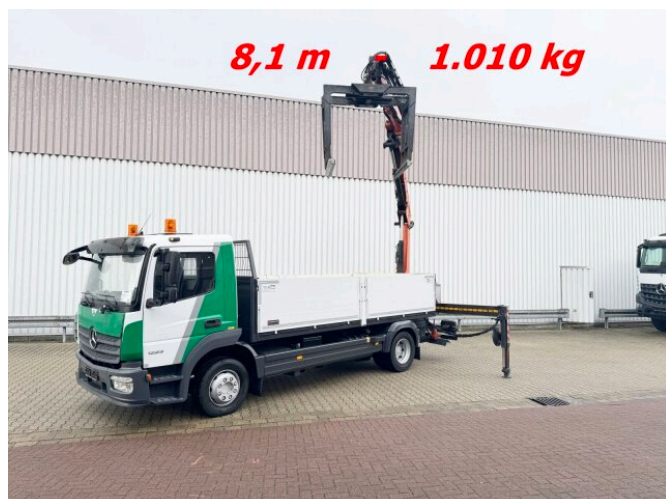
Mercedes-Benz Atego 1223 L 4x2 Atego 1223 L 4x2 mit Heckkran Atlas 88.3-A2L, Funk
