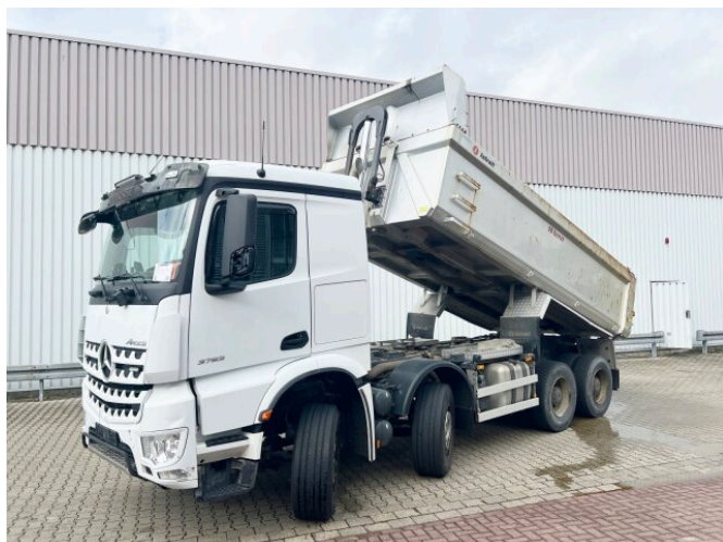
Mercedes-Benz Arocs 3253 K 8x4/4 Arocs 3253 K 8x4/4, Retarder, Stahlmulde ca. 15m³, hydr. Heckklappenöffnung
