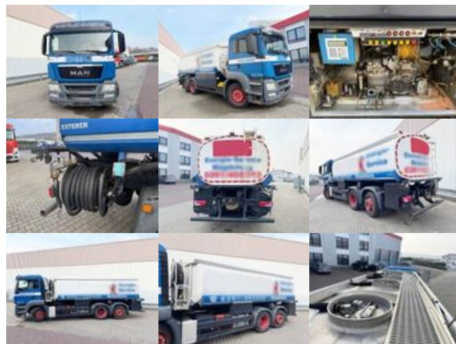
MAN TGS 26.400 6x2-4 BL TGS 26.400 6x2-4 BL, Lenk-/Liftachse, ADR, Esterer Tank ca. 20.150l, 4 Kammern
