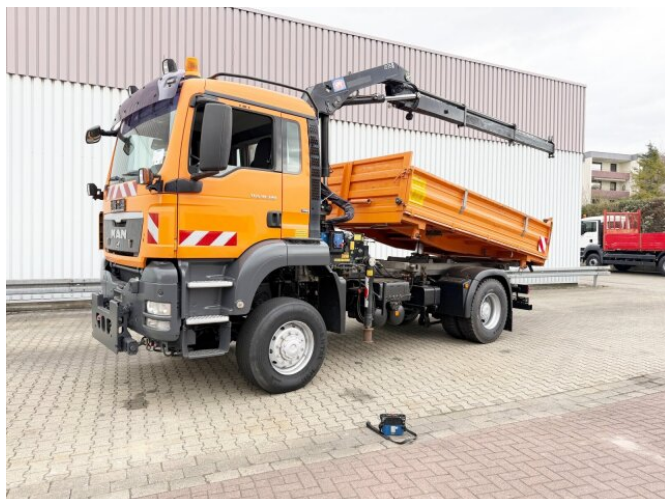
MAN TGS 18.320 4x4 BL TGS 18.320 4x4 BL, Kran, Winterdienstausstattung, Wechselsystem, HMF 1035-K2, Funk
