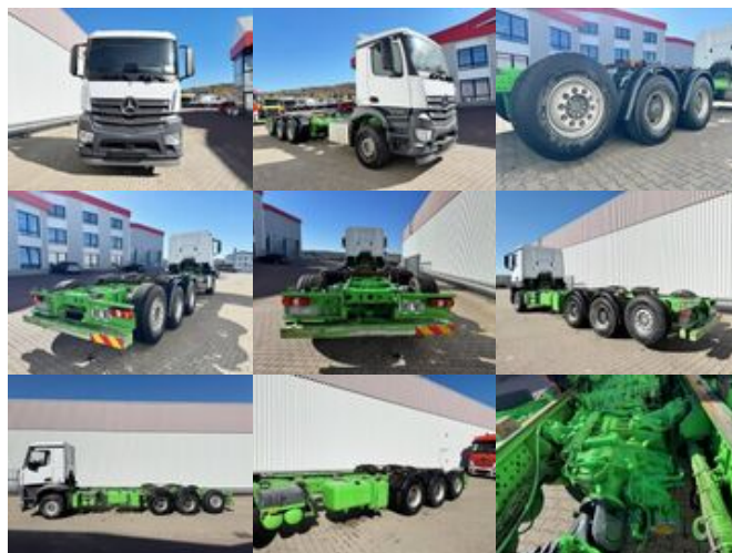
Mercedes-Benz Arocs 3242/48 LK 8x4/4 Arocs 3242/48 LK 8x4/4, Lenk-/Liftachse, Nebenantrieb
