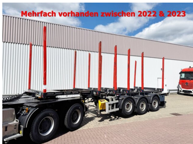
Doll LOGO H3L-14XL LOGO H3L-14XL, Liftachse, Nachlaufenkachse, teleskopierbar 9,4m-12,9
