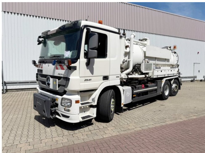
Mercedes-Benz Actros 2541 L 6x2 Actros 2541 L 6x2, Müller Saug-/Spülwagen ca. 12m³, Widi-Platte, Lift-/Lenkachse
