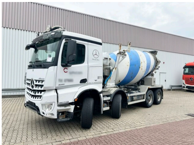
Mercedes-Benz Arocs 3251 8x4/4 Arocs 3251 8x4/4, Betonmischer Liebherr ca. 9m 3
