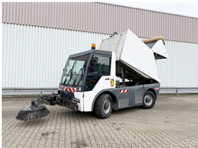
Aebi MFH 5500 MFH 5500, 4-Rad-Lenkung, 3-Besen, Hochentleerung, ca. 5m 3
