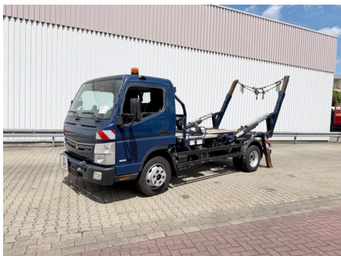
Mitsubishi Canter Fuso 7C15 4x2, Tele-Absetzer, Vereiterbar bis 10m³
