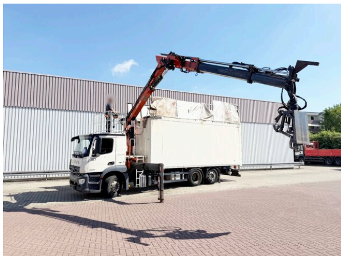
Mercedes-Benz Antos 2536 6x2/4, Kran Atlas 186.3-V2, 11.2m-1.600 kg, Funk, Walkingfloor
