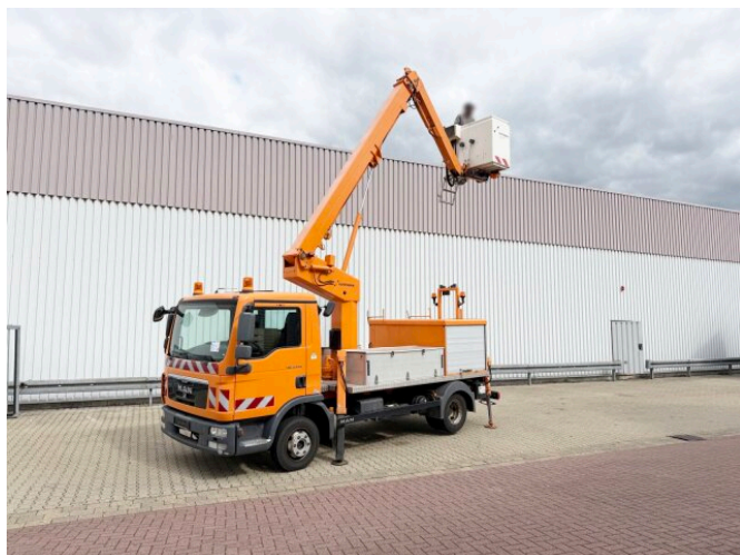
MAN TGL 8.150 4X2 BB TGL 8.150 4X2 BB, Ruthmann Steiger, Hubarbeitsbühne 23m
