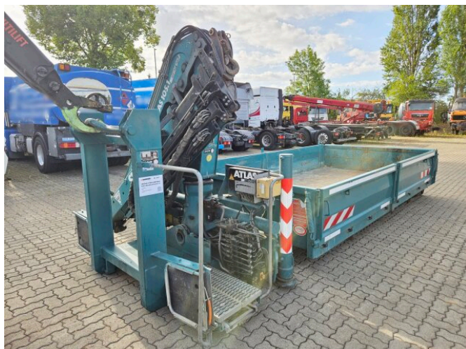
WESER CONTAINERBAU K22, Abrollcontainer mit Kran K22, Abrollcontainer mit Kran Atlas 105.1, Funk, Greifersteuerung, ca. 6,8m³
