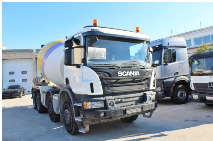
Scania Scania P 410 8x4 Scania P 410 8x4, Liebherr Mischer HTM 905, 9 cbm
