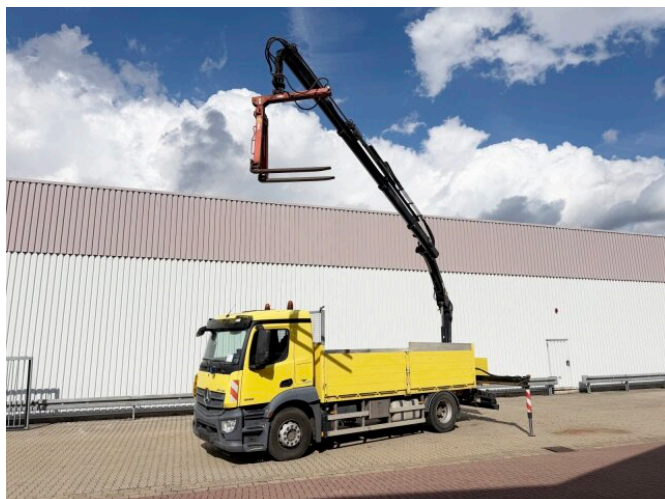
Mercedes-Benz Antos 1832 L 4x2 Antos 1832 L 4x2, Heckkran Hiab 111BS-3 HiDuo, Funk
