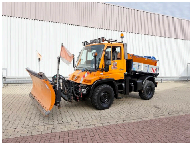
Unimog U 300 4x4 U 300 405/10 4x4, Kommunalhydraulik
