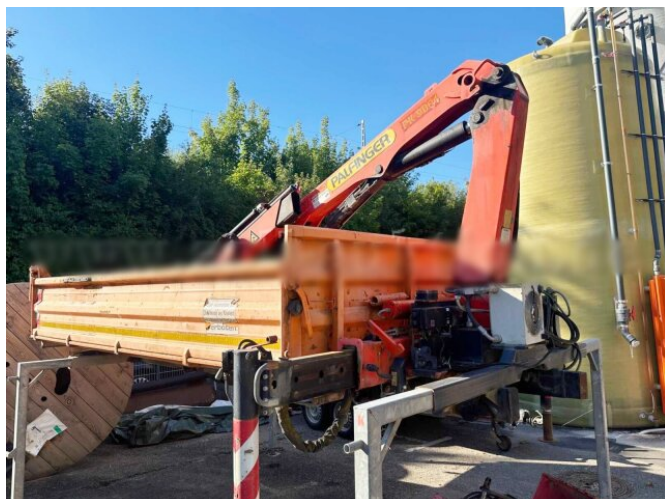
Meiller 3-S-Kippaufbau mit Kran Palfinger PK9001 3-S-Kippaufbau mit Kran Palfinger PK9001, Wechselsystem, Funk
